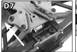
Verbinden Sie die Zentral-Antriebswellenhälften miteinander, bevor Sie die hintere Einheit an der Karosserie befestigen.
